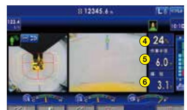
④ 負荷率表示 ⑤ 作業半径 ⑥ 揚程
