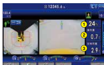
① 負荷率表示 ② 実荷重 ③ 定格荷重
